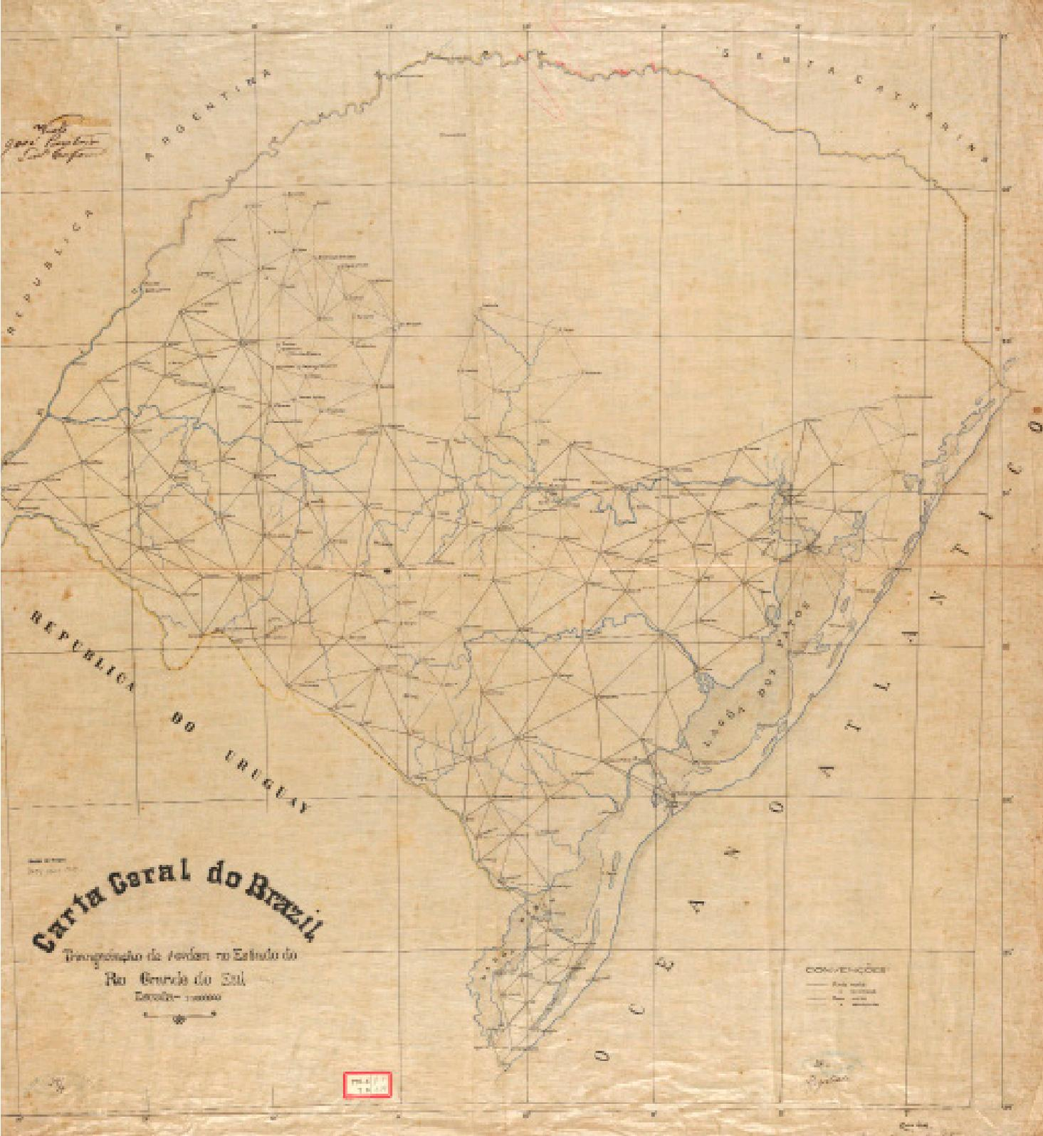
No mapa do Rio Grande do Sul de 1916, observamos a aplicação da triangulação, que é um antigo método para se fazer o levantamento topográfico em um plano, por meio de uma rede de triângulos. Ao saber a distância entre dois vértices do triângulo é possível, por cálculos matemáticos, chegar ao restante de toda a área de estudo a ser calculada.
